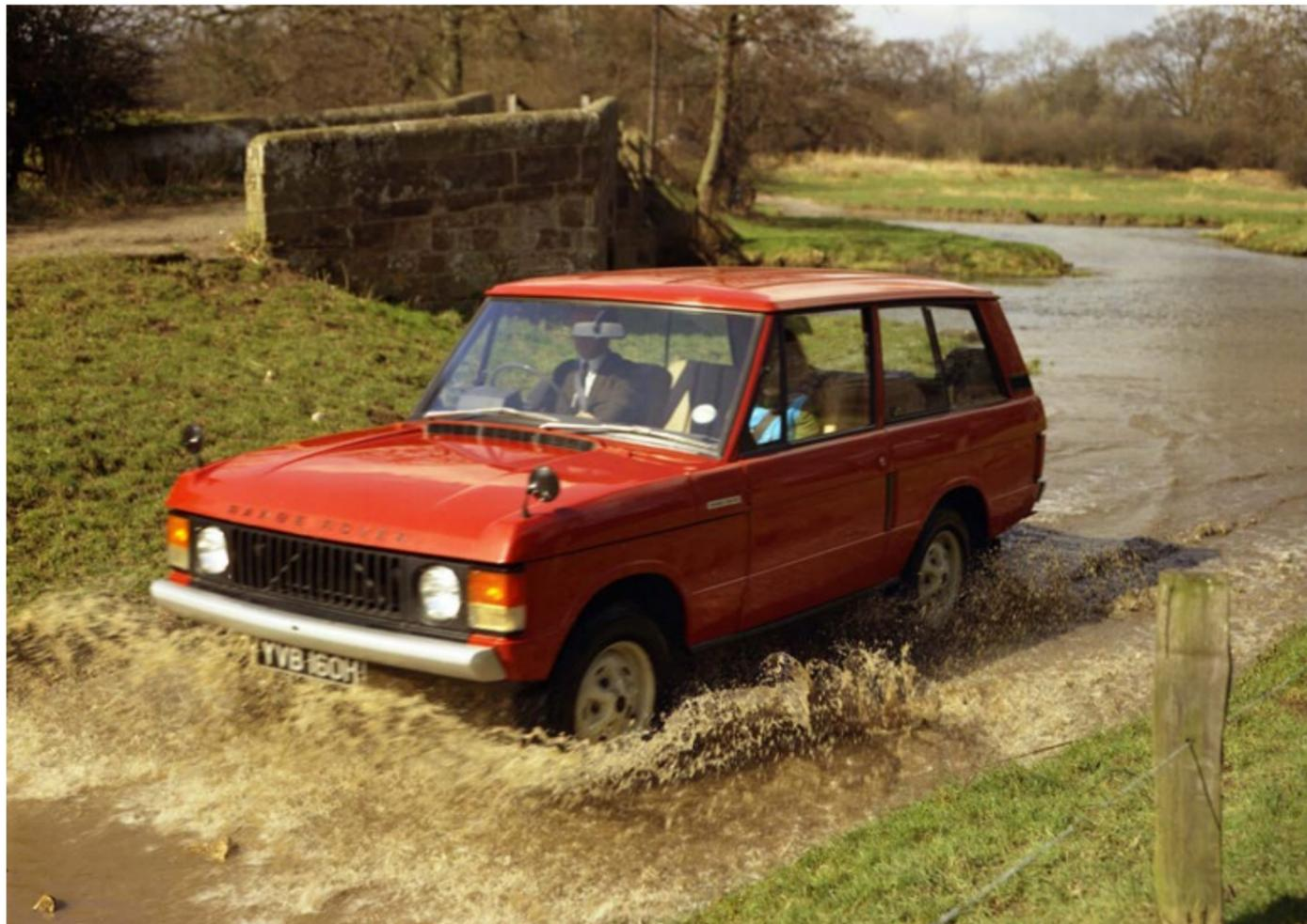
rahmen-Chassis und permanenter Allradantrieb mit sperrbarem Zentraldifferential.
