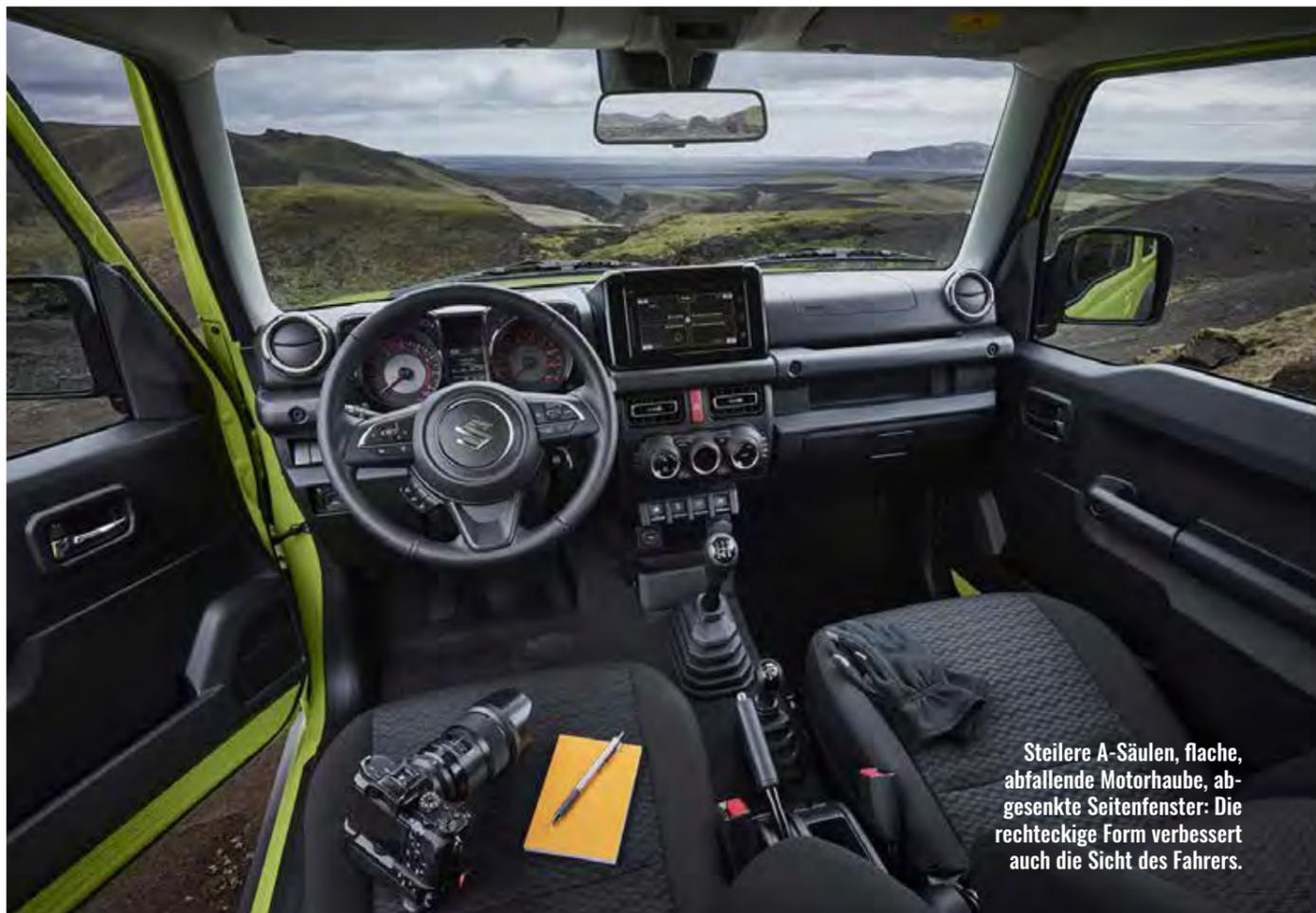
Steilere A-Säulen, flache, abfallende Motorhaube, abgesenkte Seitenfenster: Die rechteckige Form verbessert auch die Sicht des Fahrers.
