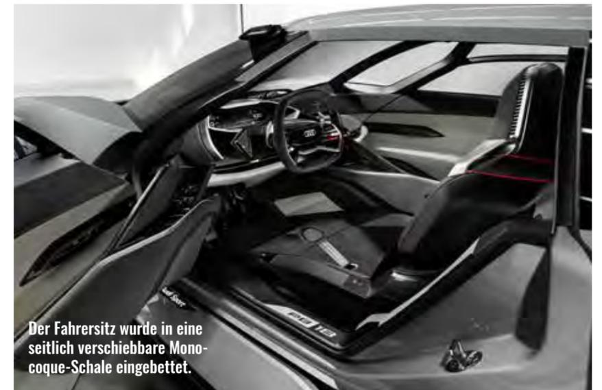
Der Fahrersitz wurde in eine seitlich verschiebbare Monocoque-Schale eingebettet.
