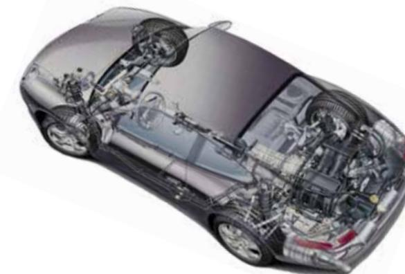
**2006: PORSCHE 911 TURBO (997)** PTM mit elektromagnetisch Lamellenkupplung.
