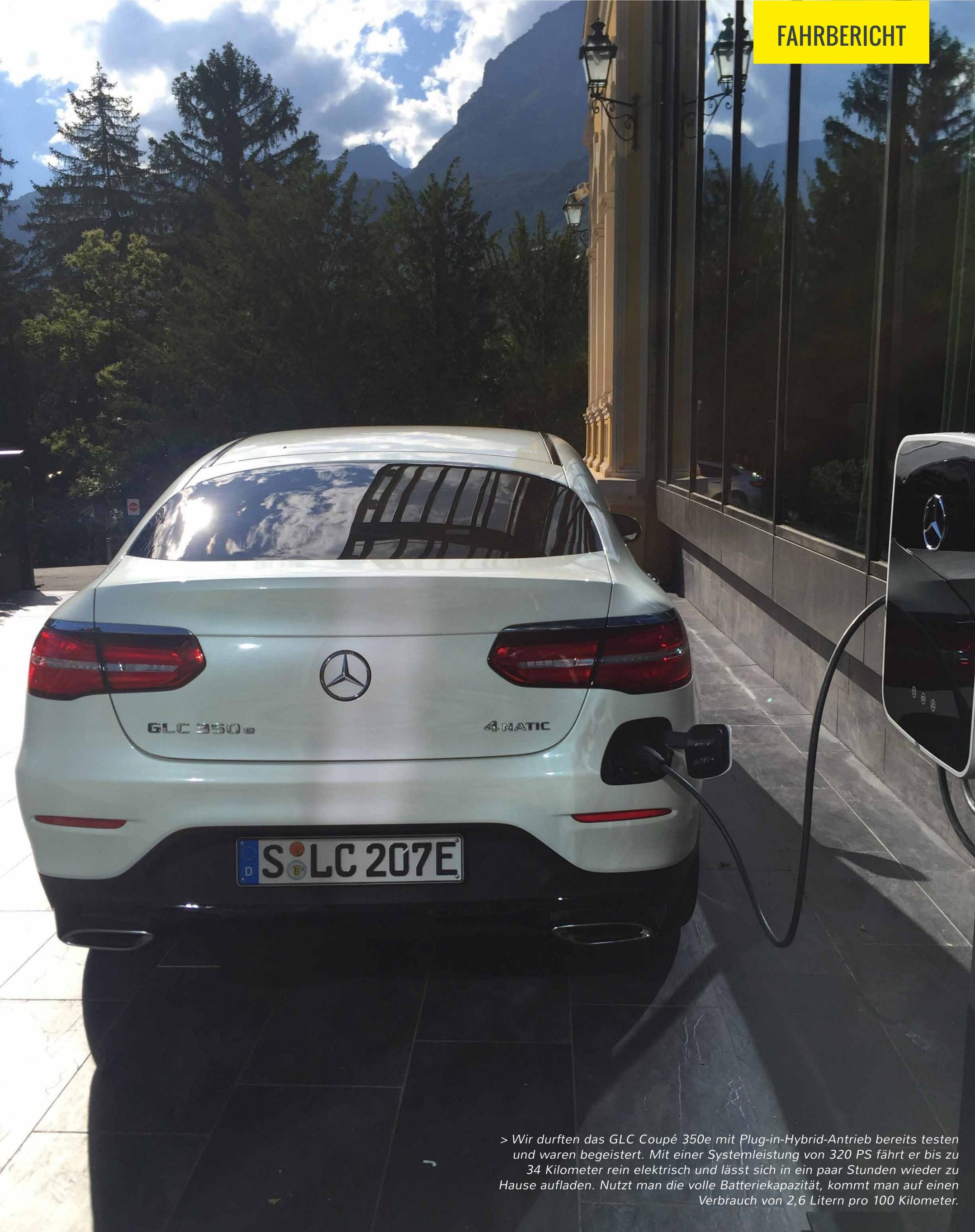
> Wir durften das GLC Coupé 350e mit Plug-in-Hybrid-Antrieb bereits testen und waren begeistert. Mit einer Systemleistung von 320 PS fährt er bis zu 34 Kilometer rein elektrisch und lässt sich in ein paar Stunden wieder zu Hause aufladen. Nutzt man die volle Batteriekapazität, kommt man auf einen Verbrauch von 2,6 Litern pro 100 Kilometer.
